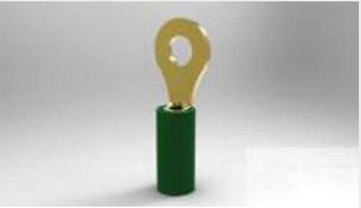
TE Part #1-332433-0 TERMINAL,PIDG PTFE R AU 22-20 6
